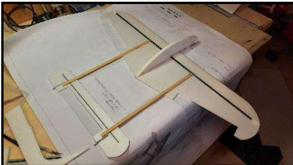
Monter la partie supérieure du fuselage en vérifiant le bon équerage ainsi que les flancs de poutres.
